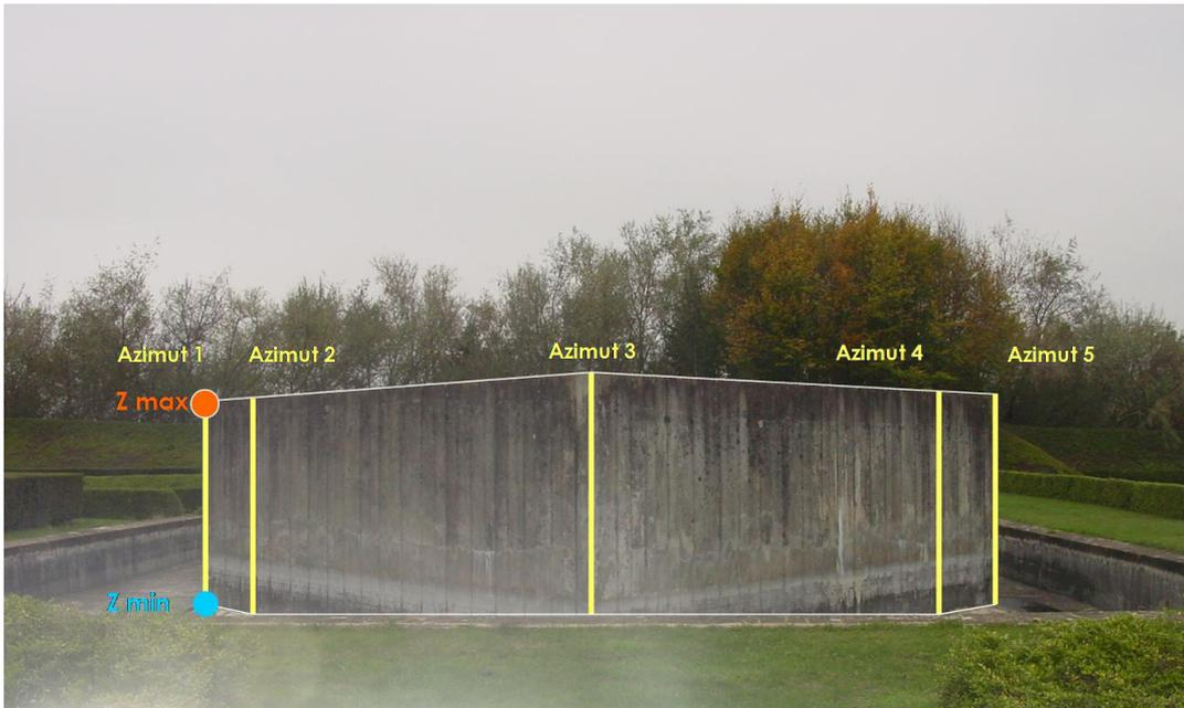
Figure 6 : segmentation d'un objet simple étudié pour un relevé au théodolite
